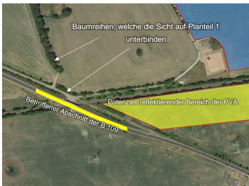
Abbildung 26: Von Blendwirkungen betroffener Abschnitt der B 109 (grobe Position). - Quelle Satellitenbild: Google Earth Pro
