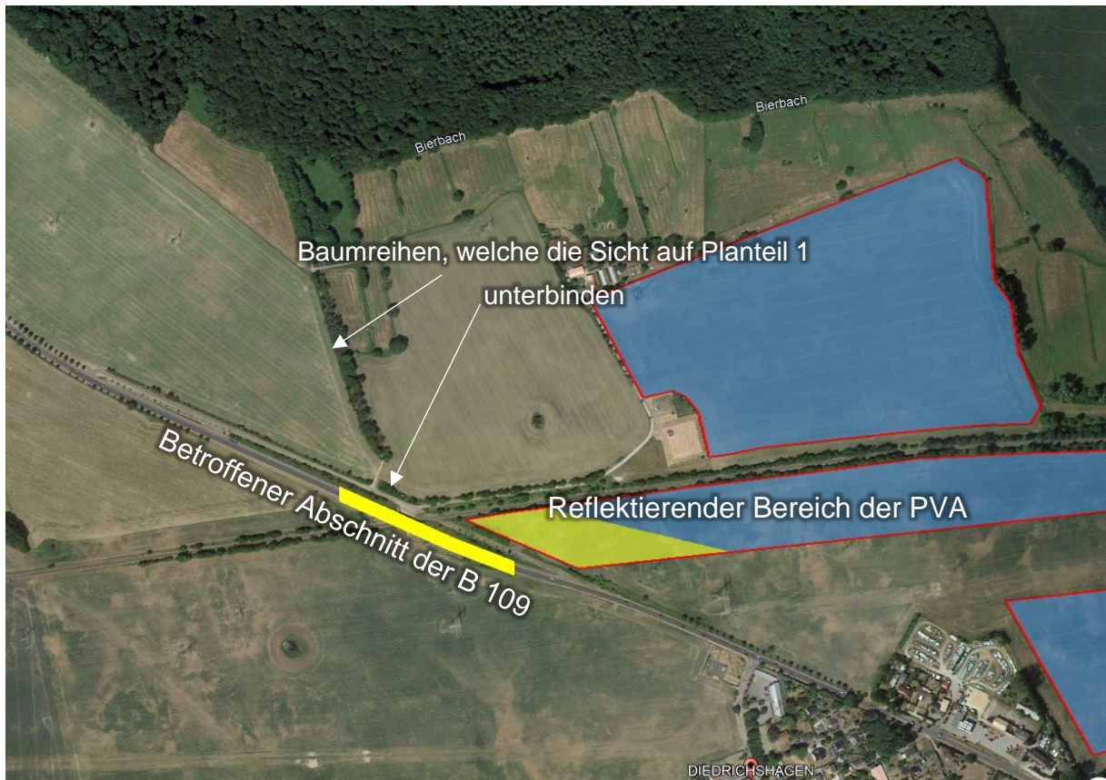
Abbildung 33: Von Blendwirkungen betroffener Abschnitt der B 109 (grobe Position). - Quelle Satellitenbild: Google Earth Pro
