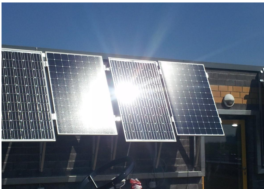
Abbildung 7: Veranschaulichung der Reflexion an einem texturierten Modulglas (mitte-links) und einem glatten Modulglas (mitte-rechts) – Quelle Aufnahme: Fraunhofer-Institut für Solare Energiesysteme ISE
