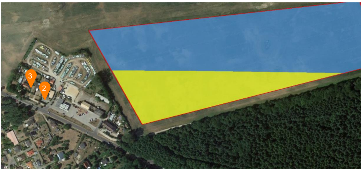
Abbildung 19: Zu OP 2 und 3 reflektierende PV-Module (grobe Position) - Quelle Satellitenbild: Google Earth Pro
